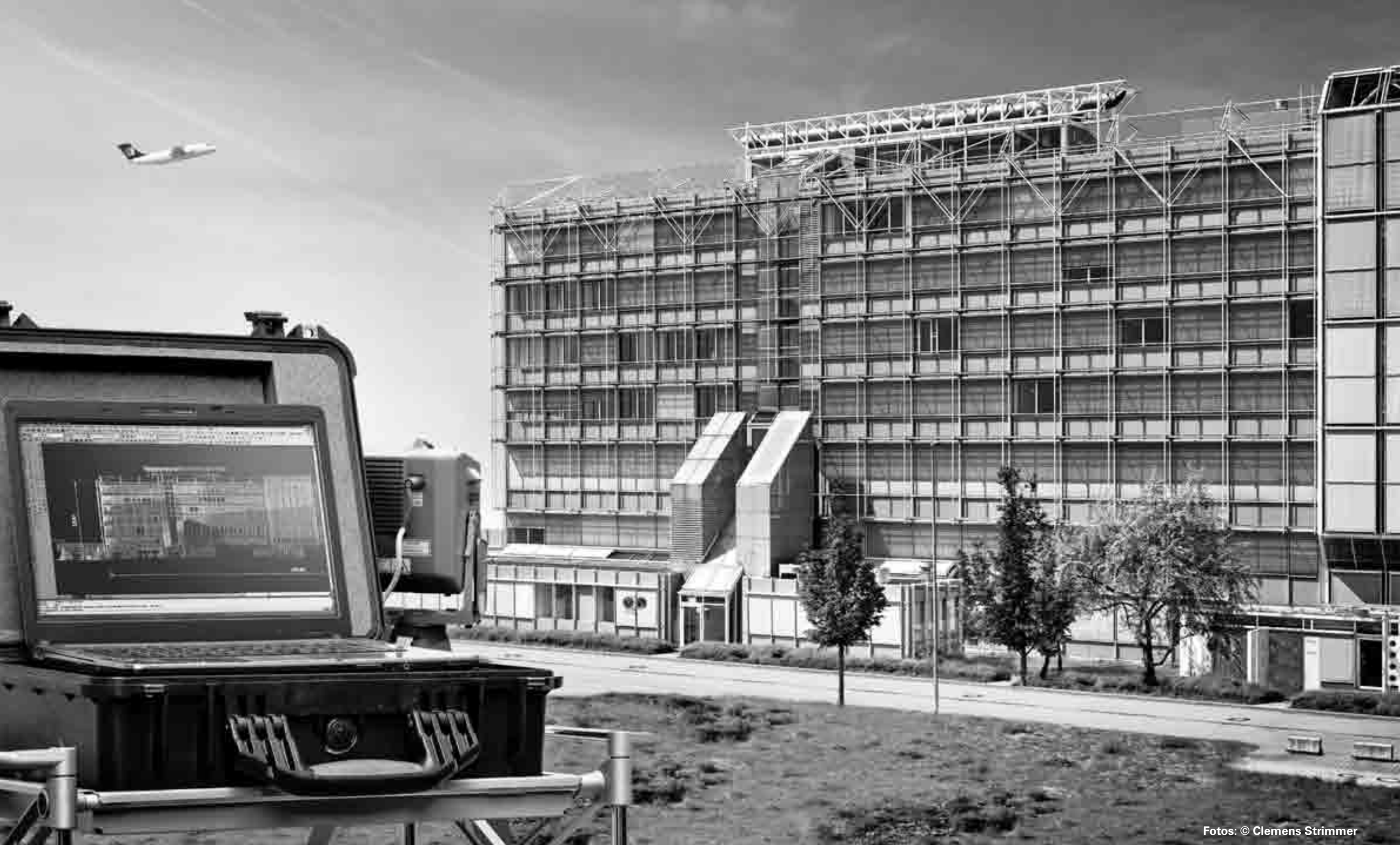
Laserscanning einer Fassade, Vermessung
