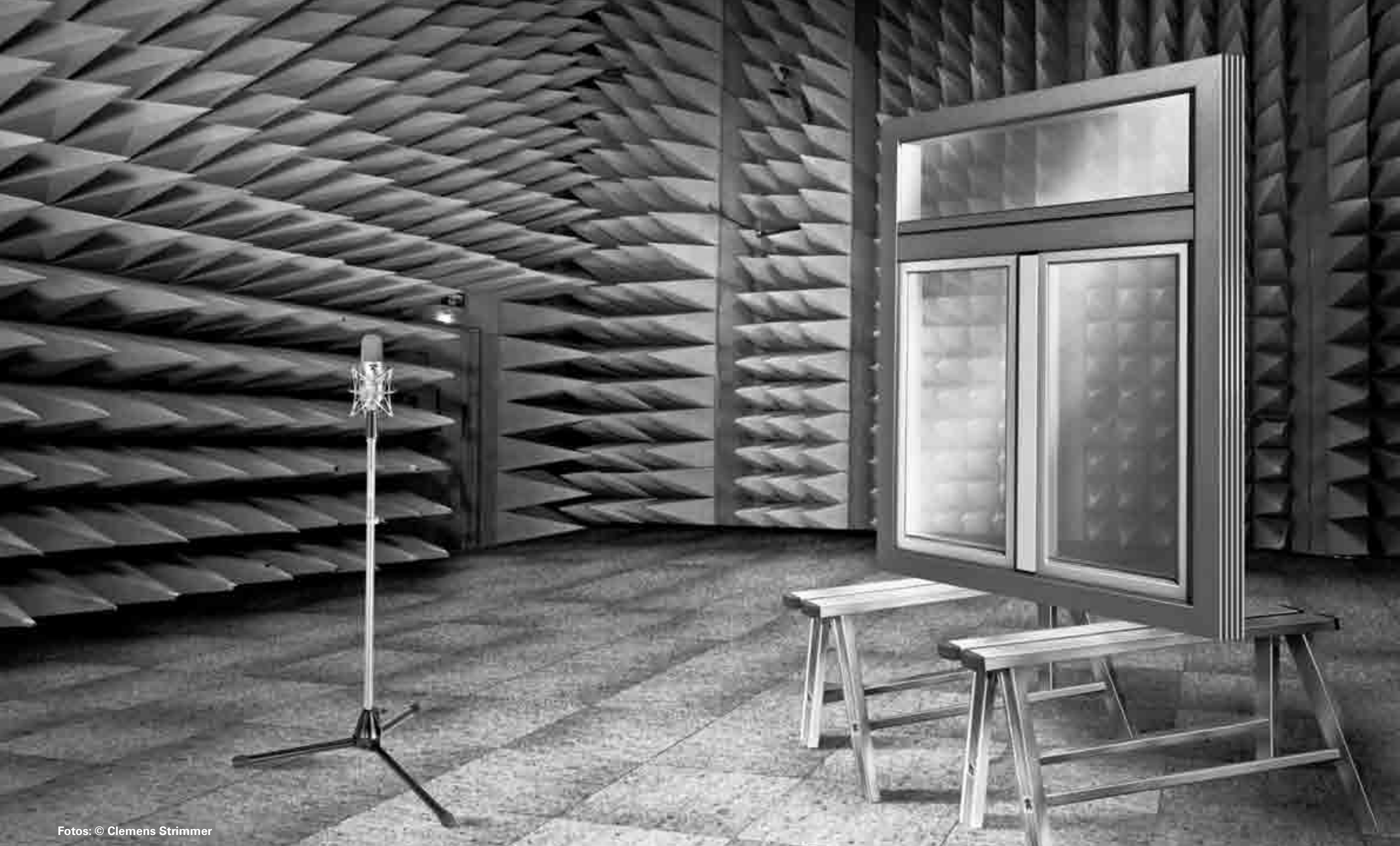
Akustiktest im Schall-Labor, Augsburg
