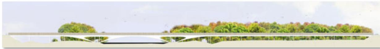
Der Siegerbeitrag der Ingenieurgruppe Bauen überzeugt mit einem schlanken Brückenentwurf in Spannbetonbauweise und besticht durch seine transparente Wirkung im Vorlandbereich und die Betonung der Flussquerung durch einen ästhetischen, wohlproportionierten Bogen. Das semi-integrale lagerlose Tragwerk zeichnet sich insbesondere auch in der technischen Qualität durch gute und durchdachte konstruktive Lösungen sowie durch seine Wartungs- und Instandhaltungsfreundlichkeit aus.
